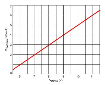
FIGURE 19. NORMALIZED RESISTOR VALUE IN PASSIVE CONFIGURATION; V<sub>VCC</sub> = 5V
