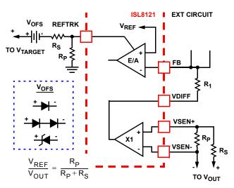
FIGURE 14. OFFSET VOLTAGE TRACKING
