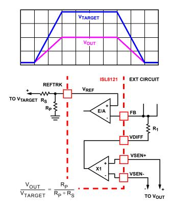
FIGURE 12. RATIOMETRIC VOLTAGE TRACKING
