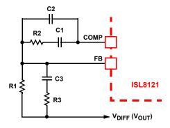
FIGURE 23. COMPENSATION CONFIGURATION FOR ISL8121 CIRCUIT
