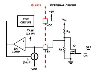
FIGURE 16. START-UP COORDINATION USING THE EN PIN
